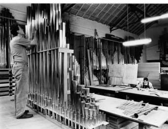
EINBAU DER METALLPFEIFEN FOTO: ORGELBAU KLAIS
